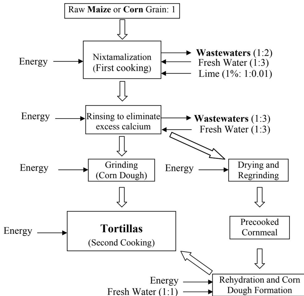
Fig. 2 Diagram for the traditional nixtamalización process [1].
