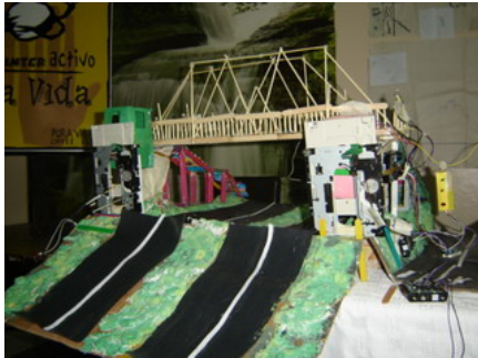
Fig 2. Construcción de un puente peatonal que brinde los requisitos de accesibilidad y seguridad a la personas, de la comunidad. Creado por un grupo de estudiantes entre 9 - 12 años, fue construido con materiales re-usados extraídos de computadores en desuso, programado con Logo Blocks y controlado con handy cricket. San José Costa Rica, mayo 2006.
